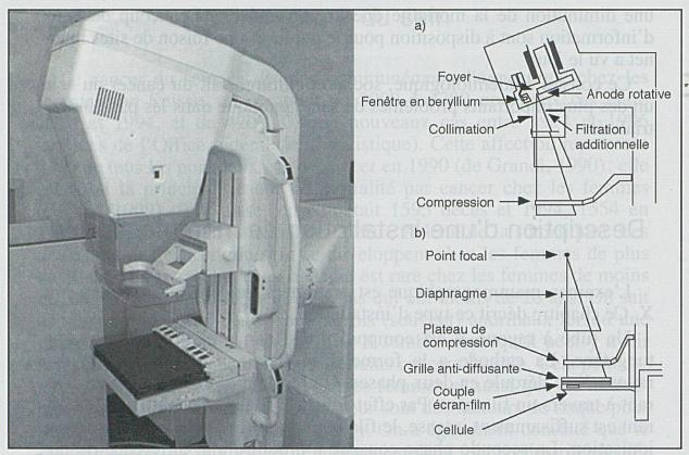
(Figure 1) A gauche: photographie d'une installation de mammographie. A droite: représentation schématique.
