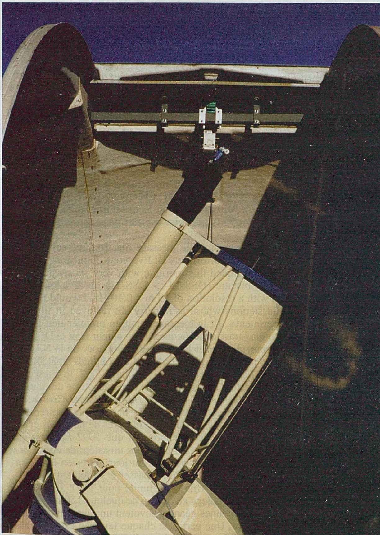
Vue du Télescope Bernard Comte de 610 mm ouvert à F/D = 3,41 . Source: Damien Lachat.
