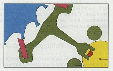
d) La dent de la roue d'échappement glisse contre l'arête de la levée. La phase de transmission d'énergie se termine.
