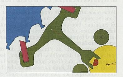
c) La dent de la roue d'échappement est libérée et se met à glisser le long du plan d'impulsion de la levée. L'énergie motrice est transmise au balancier par l'intermédiaire de l'ancre.
