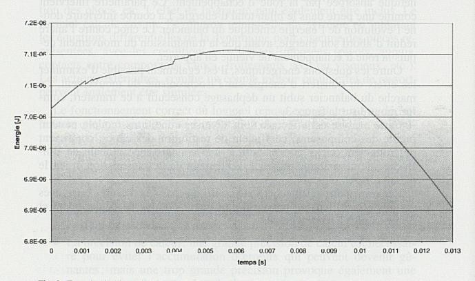
Fig. 2: Energie cinétique de la roue d'échappement et du balancier.
