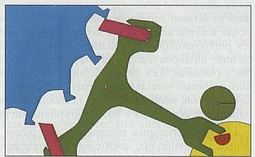
Du point de vue fonctionnel, il est important d'arriver à quantifier les échanges d'énergie, afin de connaître par exemple: quelle fraction d'énergie est transmise par choc ou par frottement, quel est le rendement global de l'échappement, quelle est l'influence des paramètres mécaniques comme le coefficient de frottement, l'inertie des composants, etc.
