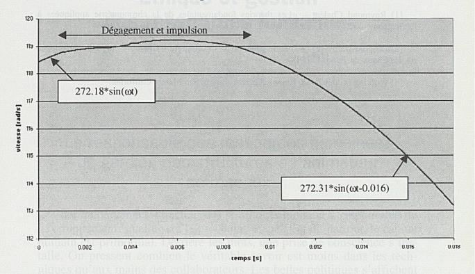
Fig. 3: Analyse de la perturbation de marche du balancier due au transfert d'énergie.
