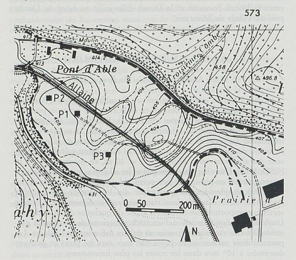
On peut distinguer les secteurs des puits nord et centre, alimentés par l'Allaine et par l'aquifère du Betteraz, et le secteur du puits sud, jamais clairement touché par un essai de traçage et dont la composition chimique des eaux (en particulier le sodium, le potassium et le sulfate) indique des apports différents, probablement du versant sudouest. Les réserves contenues dans l'aquifère peuvent être évaluées à un peu plus de 70 000 m³.
