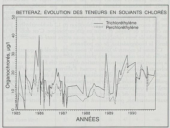
de trichloréthylène lors d'un prélèvement) n'aient jamais été retrouvées, la contamination ne montre pas de tendance à la baisse marquée malgré les assainissements effectués. Tout au plus constate-t-on que les concentrations diminuent quelque peu lors des années humides (1987 et 1988), et sont plus élevées les années sèches (1989, 1990).
