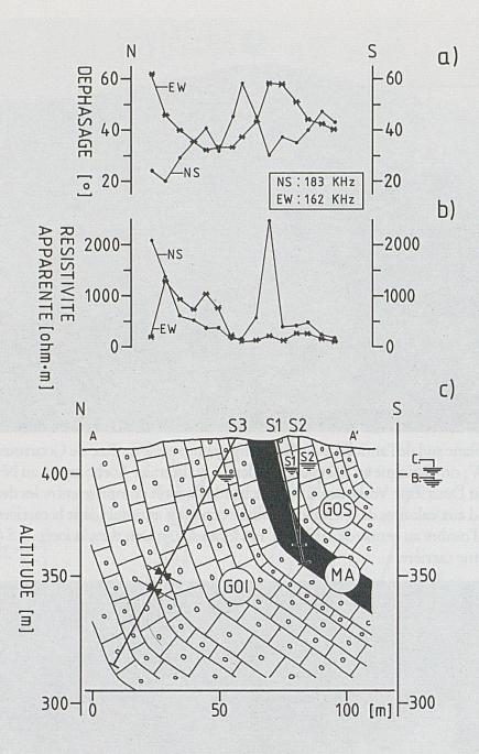
Figure 2- Profils géophysique et géologique au droit des forages S1, S2 et S3
