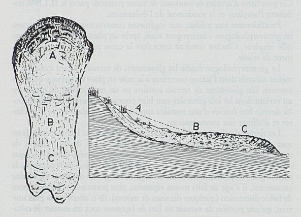
Fig. 1: Schéma d'un glissement de terrain (plan et coupe)
