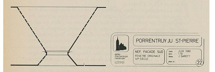
Fig. 12 Fenêtre romane dans le mur sud du bas-côté sud.
