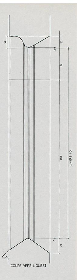
Fig. 25 Reconstitution d'une fenêtre à meneau du 15° siècle dans le mur sud du chœur.
