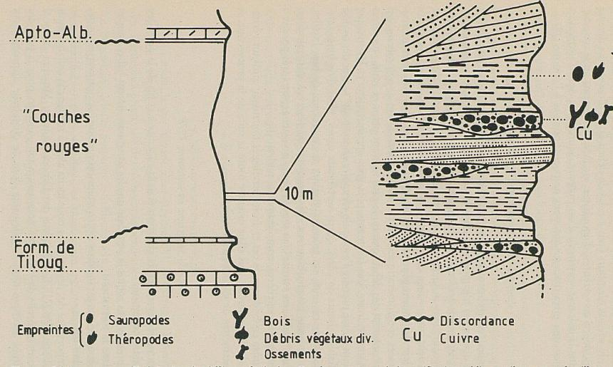
Fig. 4 Schéma montrant l'imbrication des différents faciès des «Couches rouges»: grès à stratifications obliques, silts, marnes, lentilles conglomératiques à restes végétaux et animaux. Les gisements les plus riches sont situés généralement dans le tiers inférieur des «Couches rouges», à proximité des rides tectoniques actives.
