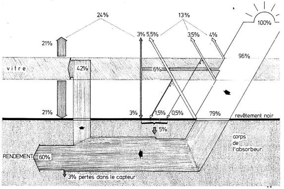
Le total des pertes, pour une température de fonctionnement de 40°C, est de 40%, soit 24% de rayonnement infra-rouge, 13% de rayonnement
