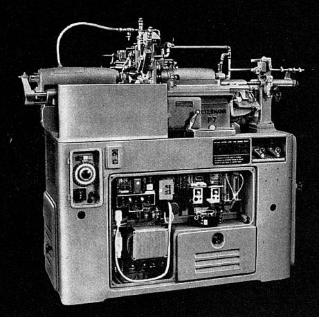
CE NOUVEAU TOUR AUTOMATIQUE ASSURE UNE PLUS GRANDE PRODUCTION GRACE AU RÉGLAGE INSTANTANÉ ET PROGRESSIF DE LA VITESSE DE L'ARBRE A CAMES PAR UN VARIATEUR ÉLECTRONIQUE
