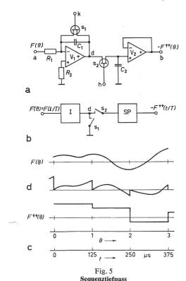
a praktische Ausführung; b Blockschema; c Zeitdiagramm; d Integration von  $F(\theta)$  I Integrator; SP Speicher; V Operationsverstärker
