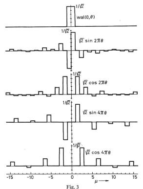
Walsh-Fourier-Transformierte  $a_{\rm c}(\mu)$  oder  $a_{\rm g}(\mu)$  der Impulse von Fig. 2  $\mu$  normierte Sequenz
