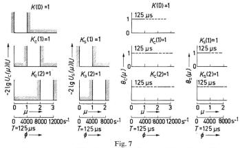
Sequenzgang von Dämpfung und Verzögerung einiger Sequenzfilter  $\theta$  Sequenz in zps;  $\mu$  normierte Sequenz
