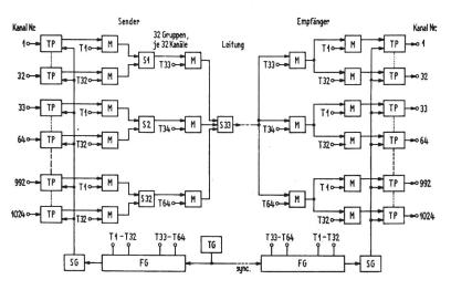
Frequenz-Multiplexübertragung sehr ähnlich sind. Fig. 9 zeigt das Blockschema eines Sequenz-Multiplexsystems für 1024 Kanäle. Die analogen oder digitalen Signale werden durch Sequenztiefpässe TP zu Multiplikatoren M geleitet. Für Telephonieübertragung ist die Bandbreite der Tiefpässe  $\Delta\phi = 4$ kzps. Den Multiplikatoren werden 32Walsh-Funktionen cal $(i,\theta)$  und sal $(i,\theta)$  mit einer Zeitbasis  $T = \frac{1}{2\Delta\phi}$  zugeführt.
