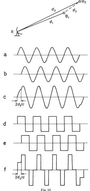
Prinzip der Formerkennung mit einem Walsh-Wellen-Radar
