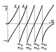
drehglieder und Bandsperren, wie der Verlauf der Reaktanzen in Fig. 13 und Fig. 14 (die Sperrbereiche sind schraffiert)wiedergibt.
