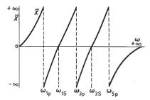
Blindwiderstandsverlauf der Anordnung in Fig. 20 in Abhängigkeit von der Kreisfre-
