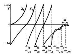
Fig. 31 Blindwiderstandsverlauf der Zweige des Tiefpasses in Fig. 30
