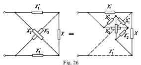
Zweigbrücke aus der Brücke in Fig. 25a mit Ersatzschaltbild
