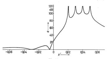
Fig. 33 Dämpfungsverlauf des Tiefpasses in Fig. 30
