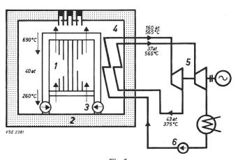
Fig. 5 Schéma thermique simplifié de la centrale nucléaire avec cuve sous pression en béton précontraint
