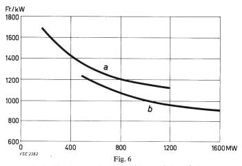
Frais d'établissement des centrales Magnox à deux réacteurs a cuve sous pression en acier b cuve sous pression en béton précontraint
