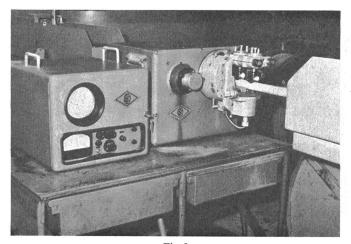
Fig. 3 Messgerät für Exzentrizität
