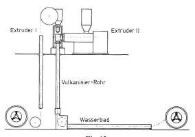
Fig. 12 CV-Vertikalanlage
