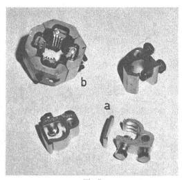
Bei den in Fig. 7 gezeigten Klemmen, die auf die einzelnen Adern bzw. auf das ganze Aderbündel aufgesetzt und mit einem isolierten Schlüssel angezogen werden, fällt das Abisolieren und damit der direkte Kontakt des Monteurs mit dem spannungführenden Leiter weg. Über die Vorund Nachteile dieser Klemmen liegen noch zu wenig Erfahrungen vor, um ein abschliessendes Urteil zu fällen.
