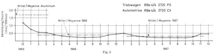
Frotteurs en matériaux mixtes Usure spécifique des frotteurs en mm/1000 km
