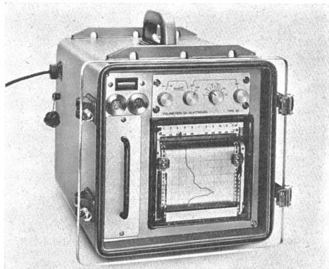
trisch aufgezogen. Eingebaute Trocknungspatronen dienen dem Schutz vor Kondenswasserbildung. Der jeweilige Ladezustand der steckbaren Batterie ist am eingebauten Kontrollinstrument ersichtlich. Ergänzt durch geeignete Messwertgeber, z. B. mit Schwimmerkörper für Kanalisationen, gibt dieser Linienschreiber Aufschluss über den pH- oder Redoxpotentialverlauf in Gewässern oder an Schlüsselstellen der chemischen Verfahrenstechnik.
