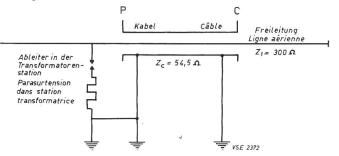
Si une surtension avec une raideur de front  $S_1$  en  $kV/\mu s$  arrive sur le câble par la ligne aérienne, il y a réflexion au point C, dont le facteur de réflexion a la valeur suivante:
