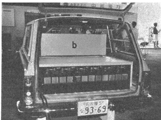
Fig. 27 Electromobile de 6 kW de la Chubu Electric Power Co. a Accumulateurs au zinc de 120 Ah; b dispositif de charge
