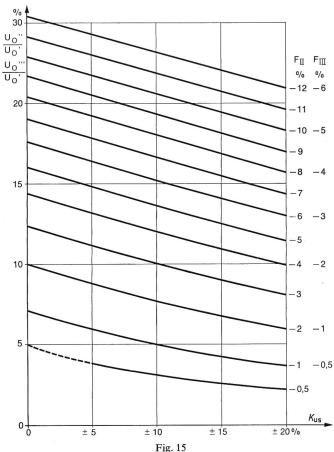
Abaque des erreurs  $F_{\rm III}$  et  $F_{\rm III}$ , sous charge asymétrique, en fonction des rapports  $U_0''/U_0'$  et  $U_0'''/U_0'$
