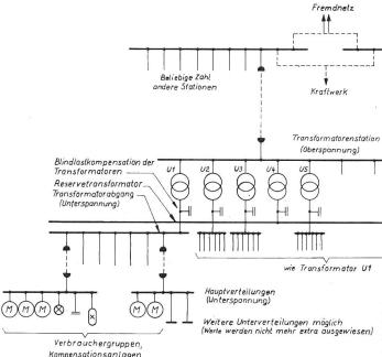
Fig. 2 Vereinfachtes Übersichtsschema für das untersuchte Energieversorgungsnetz [72]
