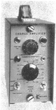
beträgt  $\pm 20$  mA. Der grosse Frequenzbereich (quasistatisch bis 150 kHz) bleibt auch bei kleinen Signalen und langen Eingangskabeln erhalten.
