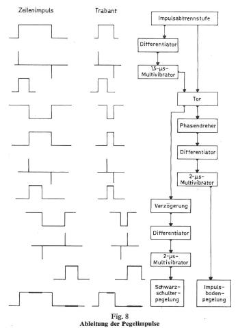
1,5 µs breite Störimpulse dürfen keine Pegelimpulse erzeugen. Die Pegelung auf dem Synchronimpulsboden darf nie länger dauern als der Synchronimpuls selbst (Trabant)
