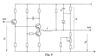
Einstufige Korrektur der aussteuerungsabhängigen Phasenverschiebung Das RCL-Netzwerk bildet einen Pol, dessen Knickfrequenz beim Übergang der Diode vom gesperrten in den leitenden Zustand von  $\omega/\omega_0$   $\leqslant 1$  auf  $\omega/\omega_0 < 1$  geschoben wird
