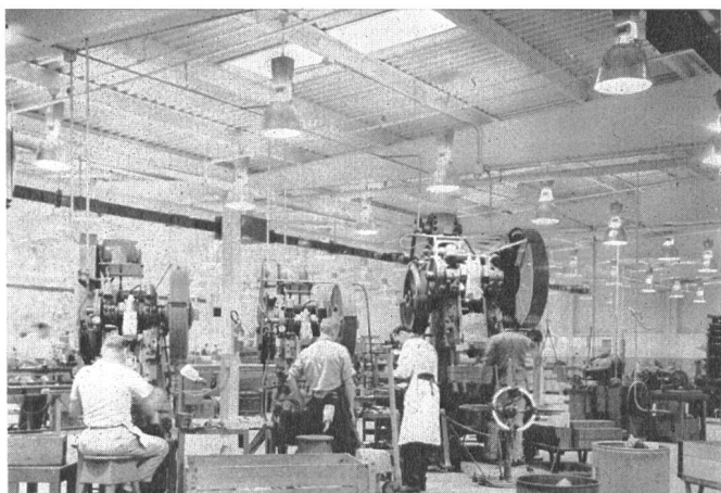
Fig. 3 Stanzerei in einer Industriehalle, beleuchtet mit Quecksilber-Halogenlampen
