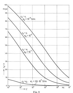
Frequenzabhängigkeit der Wellengeschwindigkeiten auf der Versuchsleitung (vgl. Fig. 2)
