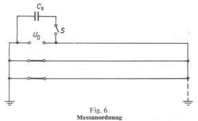
$C_s$  Schwingkapazität;  $U_0$  Ladespannung von  $C_s$ ; S idealer Schalter
