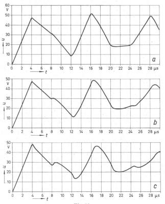
Für die Versuchsleitung berechnete Einschwingspannungen in der Anordnung gemäss Fig. 5a (vgl. Fig. 5b und 8)
