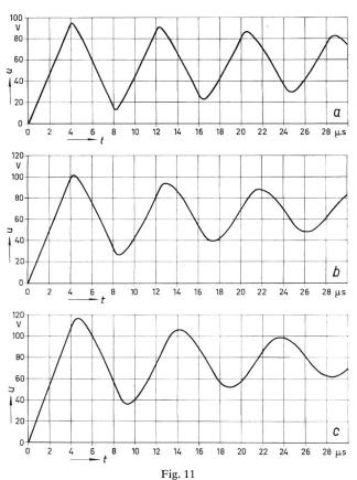
Für die Versuchsleitung berechnete Einschwingspannungen in der Anordnung gemäss Fig. 10  $a \quad K_{\rm E} = 10^{-1} \; {\rm S/m}; \quad b \quad K_{\rm E} = 10^{-2} \; {\rm S/m}; \quad c \quad K_{\rm E} = 10^{-3} \; {\rm S/m}; \quad K_{\rm E} \; {\rm Erdleitfähigkeit}$
