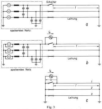
**Dreipoliger Abstandskurzschluss mit Erdberührung** *a* wirklicher Kurzschlusskreis; *b* Ersatzschaltung zur Ermittlung der unbeeinflussten Einschwingspannung; *c* Ersatzschaltung bei kurzge-
