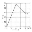
Fig. 15 Für die Anordnung der Fig. 5a berechnete Einschwingspannung an der Phase 1 der Versuchsleitung bei Berücksichtigung der Unsymmetrie
