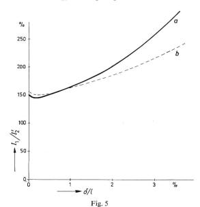
Primärstrom in Abhängigkeit von der relativen Luftspaltlänge im Kern bei warmgewalztem Blech und kornorientiertem Blech mit konstantem Laststrom für einen einpulsig belasteten Transformator für ein durchgerechnetes
