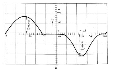
Fig. 6 Oszillogramme des Laststromes und des Primärstromes bei einem einpulsig belasteten Transformator, entsprechend der graphischen Ermittlung auf Fig. 4 a Laststrom; b Primärstrom, zusammengesetzt aus dem Magnetisierungsstrom und dem transformierten Laststrom i<sub>1</sub>, i<sub>2</sub>' primärer und transformierter sekundärer Transformatorstrom; iu Magnetisierungsstrom; B Breite des Laststrom-Impulses
