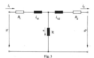
Vereinfachtes Ersatzschaltbild des Transformators  $R_1$ ,  $R_2$  Kupfer-Wicklungswiderstände;  $L_{\rm S1}$ ,  $L_{\rm S2}$  Streuinduktivitäten der Wicklungen; M Gegeninduktivität der Wicklungen;  $i_1$ ,  $i_2$  primärer und sekundärer Transformatorstrom;  $u_1$ ,  $u_2$  primäre und sekundäre Transformatorspannung; e magnetisierende Spannung
