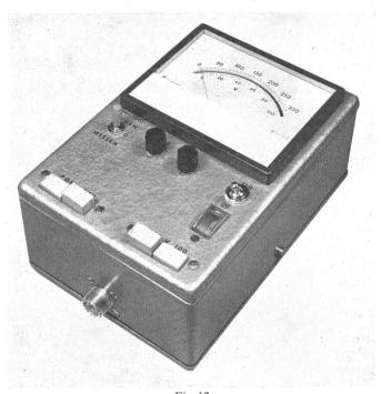
Fig. 12 Impulsmessgerät Abmessungen: 19×13×9 cm
