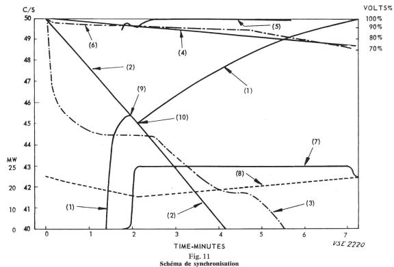
(1) Fréquence du turbo-alternateur à gaz; (2) Fréquence du réseau d'interconnexion (spécifiée); (3) Fréquence du réseau d'interconnexion (15 mai 1961); (4) Tension en volts du réseau d'interconnexion (spécifiée); (5) Tension en volts du turbo-alternateur à gaz; (6) Tension en volts du réseau d'interconnexion (15 mai 1961); (7) Production du turbo-alternateur à gaz (à 15 °C); (8) Charge auxiliaire du groupe; (9) Synchronisation; (10) Ouverture de l'interrupteur du transformateur du groupe
