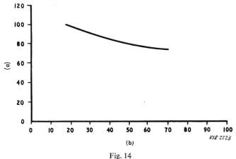
Coût de turbines à gaz en fonction de leur puissance (a) Coût en %; (b) Puissance du groupe en MW
