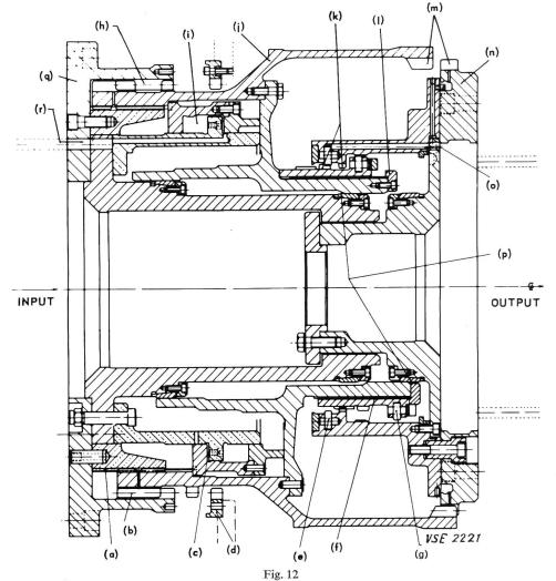
Coupe d'un embrayage à déplacement automatique synchronisé
