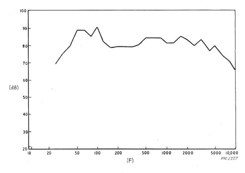
Fig. 18 Niveaux du bruit à l'intérieur de la salle des turbines
