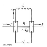
springt von  $+I_K$  auf  $-I_K$ . Da hiebei die kritische Stromstärke nie überschritten wird, kann kein Spannungsabfall U auftreten, so dass der Strom  $I_L = +I_K$  unverändert weiter fliesst. Die Information des Schreibimpulses ist nunmehr als Kreisstrom  $I_L = I_R = I_K$  gespeichert.
