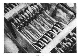
Fig. 5 Defekte Elemente einer 22jährigen Zelle
