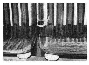
Fig. 6 Zwei Zellen einer 1296-Ah-Batterie
