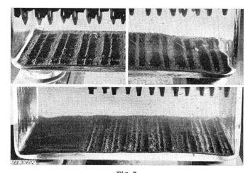
Fig. 7 3 Schlammbilder von 3 Zellen verschiedener Fabrikate einer 432-Ah-Batterie in Pufferbetrieb
