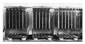
Fig. 2 180-Ah-Batterie 15 Jahre im dauernden Ladeerhaltungsbetrieb
