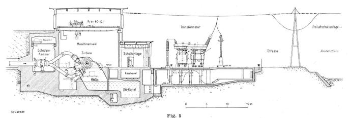
Querschnitt durch das Maschinenhaus des Kraftwerkes Tavanasa
