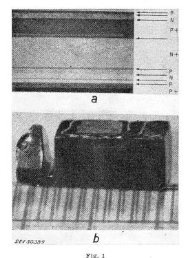
Sägezahngenerator aus einem Mehrschichthalbleiter
