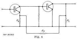
Gegenkopplung über zwei Stufen  $R_c$  Kollektorwiderstand;  $R_t$  Gegenkopplungswiderstand;  $R_f$  Gegenkopplungswiderstand
