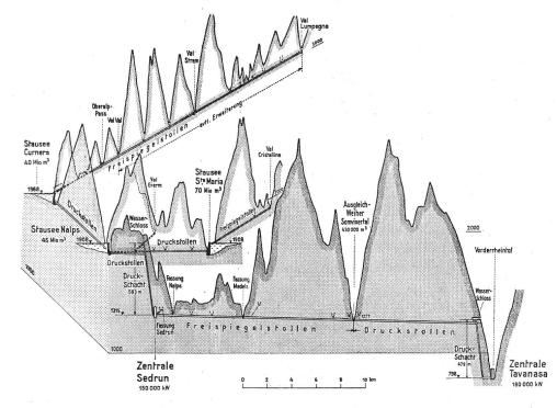
Fig. 2 Längenprofil der Kraftwerke Vorderrhein Jahresmittel  $221 \cdot 10^6$  kWh Winter- und  $35 \cdot 10^6$  kWh Sommerenergie erzeugen wird.
