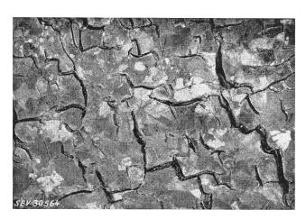
Fig. 4  ${\bf Bleimantel\text{-}Zersetzung}$  an einem 12-kV-Kabel  $3 \times 185~{\rm mm^2}$  (vergrössert)
