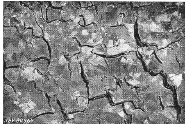
Fig. 4 Bleimantel-Zersetzung an einem 12-kV-Kabel 3 \times 185 \text{ mm}^2 (vergrößert)
