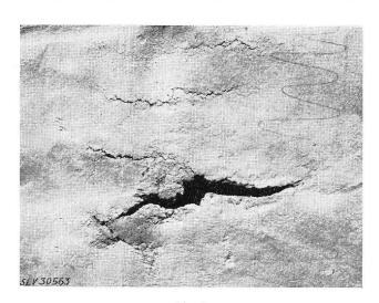
$\begin{tabular}{ll} Fig. 3 \\ Bleimantel-Zersetzung \\ an einem Niederspannungskabel $3\times150+95$ mm$^2$ \end{tabular}$
