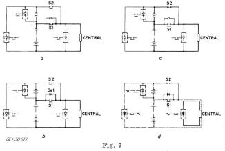
Commutation en cas de panne de réseau  $a\ 1^{re}$  phase;  $b\ 2^e$  phase;  $c\ 3^e$  phase;  $d\ après$  réapparition du réseau; Se 1 valve de couplage; S 1, S 2 commutateurs de batterie
