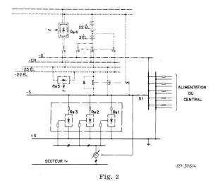
1<sup>re</sup> étape, 48 V, 600 A ÷ S, — S Barres de service; Re 1...3 Redresseur d'alimentation; — D Barre de détournement; — CH Barre de charge; Re 4, Re 5 Redresseur de charge; S 1 Sectionneur
