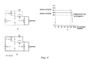
Commutation en cas de surcharge a Service normal; b Service en cas de surcharge; c Caractéristique du redresseur d'alimentation; S 1, S 2 Commutateurs de batterie
