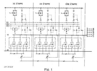
Installation complète 48 V, 2000 A (Principe)
