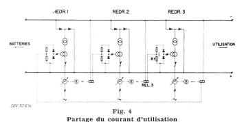
On obtiendra d'autre part, grâce à la chute de tension dans la résistance R1 augmentant avec le courant débité par le redresseur, une tension de départ sur la barre de service qui augmente elle aussi en fonction de ce courant, ce qui permet par un choix judicieux des éléments du circuit, de compenser la chute de tension dans les câbles entre la source d'alimentation et le central.
