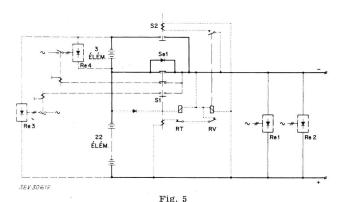
Commutation des batteries à 22/25 éléments (Principe)
