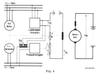
Funktionswechsel der Energieversorgungsanlage auf Generator-Motorbetrieb
