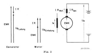
Erregung bei Generator- bzw. Motorbetrieb IR Spannungsabfall;  $i_e$  Erregerstrom;  $U_B$  Batteriespannung
