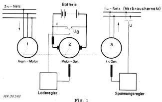
Schema einer Energieversorgungsanlage im Normalbetrieb Speisung vom Netz
