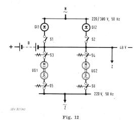
Prinzip einer Energieversorgungsanlage 220 V, 50 Hz, für Koaxialkabelverstärker
