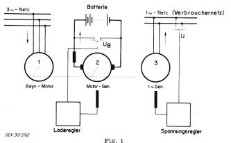
Schema einer Energieversorgungsanlage im Normalbetrieb Speisung vom Netz
