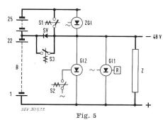
Prinzipschaltung einer 48-V-Energieversorgungsanlage mit Unterteilung der Batterie und Zusatzgleichrichter ZGl Das Sperrventil SV ist im Normalbetrieb durch S3 kurzgeschlossen. Der Gleichrichter Gl2 wird durch S2 nach Bedarf zugeschaltet Weitere Bezeichnungen siehe Fig. 3
