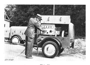
Fahrbare Notstromanlage auf Einachsanhänger Leistung 17 kVA, 220/380 V, 50 Hz, mit Antrieb durch Benzinmotor
