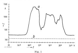
Belastungsdiagramm einer 48-V-Gleichstromspeiseanlage eines grossen Fernmeldezentrums
