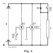
Prinzip einer 48-V-Energieversorgungsanlage mit Gegenzellenelement GZ
