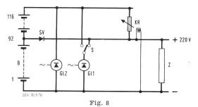
Prinzipschaltung einer Energieversorgungsanlage für Anodenspannung 220 V mit Kohledruckregler KR, Batterieanzapfung bei 92 Zellen und Sperrventil SV
