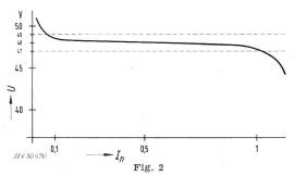
Belastungskennlinie eines Gleichrichters für 48-V-Energieversorgungsanlagen
