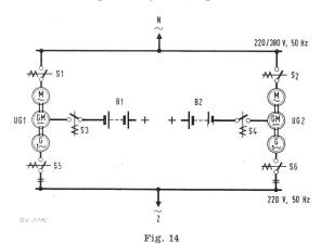
Prinzip einer Energieversorgungsanlage 220 V, 50 Hz für Koaxialkabelverstärker bei Leistungen über 10 kVA Bezeichnungen siehe im Text
