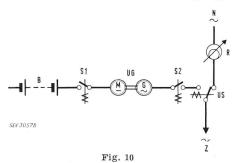
Prinzip einer Wechselstromspeiseanlage 220/380 V, 50 Hz, für Leistungen bis 20 kVA, mit maximal 6 s Unterbruch bei Netzausfall Bezeichnungen siehe im Text
