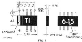
Aussehen und Abmessungen einer hermetisch vergossenen Halbleiter-Schaltungsgruppe Masse in mm
