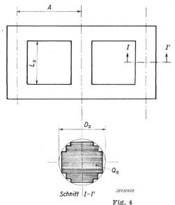
Schematisches Eigengestell des Transformators
