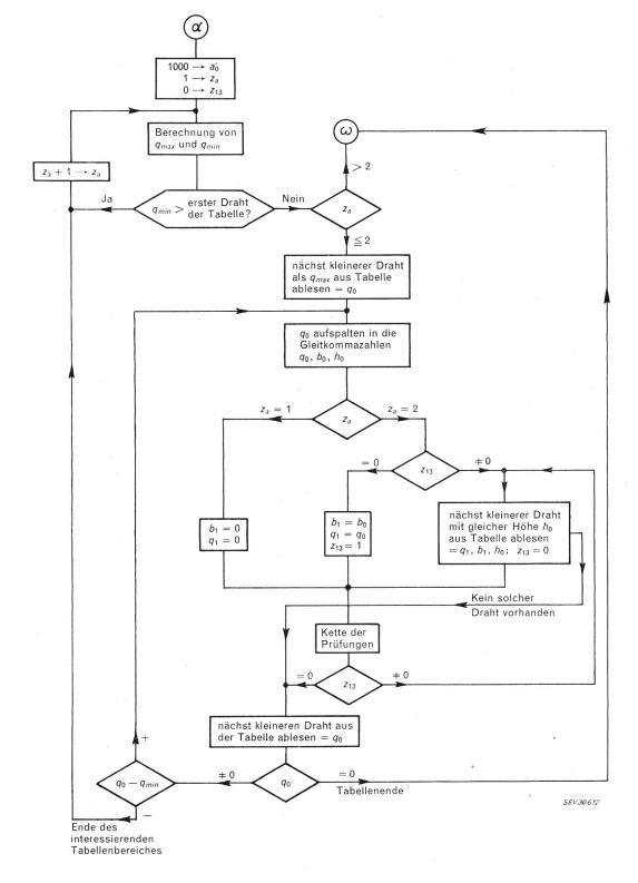
$\begin{array}{c} \textbf{Fig. 8} \\ \textbf{Endgültiges Blockdiagramm} \\ \textbf{für die Lagenwicklung} \\ z_a \ \textbf{Anzahl der parallelen Drähte} \end{array}$
