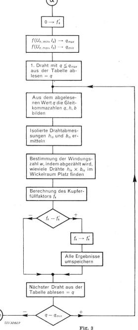
Blockdiagramm für das Entwurfsprogramm von Polradwicklungen Die rechteckigen Felder bedeuten irgendwelche Arbeiten, die die Rechenmaschine durchführen muss (Rechnungen oder ganze, in sich geschlossene Programme)
