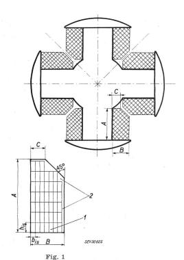
Polrad einer 4poligen Synchronmaschine mit dem zur Verfügung stehenden Wickelraum
