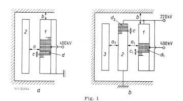
Disposition des bobines et isolations a d'un transformateur élévateur; b d'un autotransformateur d'interconnexion
