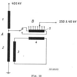
Schéma de couplage monophasé d'une unité de réglage comprenant un autotransformateur (A) et un transformateur série (B)
