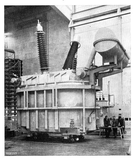
un canal d'huile. Dans une exécution de Brown Boveri (fig. 12), toutes les connexions électriques même, entre les deux transformateurs partiels, ont lieu dans huile.
