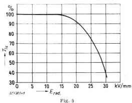
Réduction de la rigidité diélectrique axiale d'une bobine par augmentation de la contrainte radiale vis-à-vis de la bobine voisine
