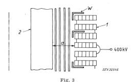
Renforcement de l'isolation axiale de la bobine haute tension au moyen d'une cornière W
