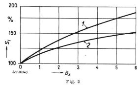
Augmentation de la sécurité à la perforation d'un canal de dispersion d'une largeur de 100 mm avec division croissante par barrières de presspan de 5 mm d'épaisseur
