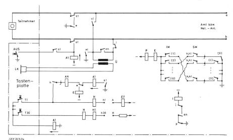
Durch die Kontakte der Speicherrelais werden die Ausgänge der beiden Zählmagnete entsprechend der zu wählenden Rufnummer miteinander verbunden. Die Rangierung wird am Montageort vorgenommen und kann jederzeit geändert werden (ein Rangierungsbeispiel zeigt Fig. 5).
