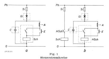
a für kleinere Schütze; b für grössere Schütze Sch Schütz; HSch Hilfsschütz; C Kondensator für Ausschaltverzögerung; Gl Gleichrichter; A «Aus»-Druckknopf; E «Ein»-Druckknopf; Si Steuersicherung
