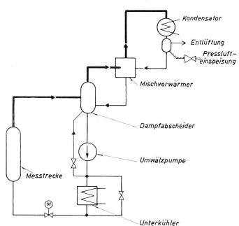
duzierventil und unterbricht die Einspeisung weiterer Pressluft. Da aber über die Entlüftung weiterhin Luft aus dem Kondensator entweicht, werden die Wärme- übergangsverhältnisse auf der Dampfseite des Kondensators verbessert und die jetzt grössere Dampfmenge wird kondensiert. Der Druck fällt, und bei Erreichen des am Reduzierventil eingestellten Sollwertes öffnet dieses wieder und speist weiter Pressluft in den Kondensator ein.
