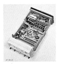
Fig. 15 Chassis eines Druckbügelreglers
