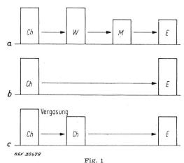
Blockschemata der Umwandlung chemischer (Ch) in elektrische (E) Energie
