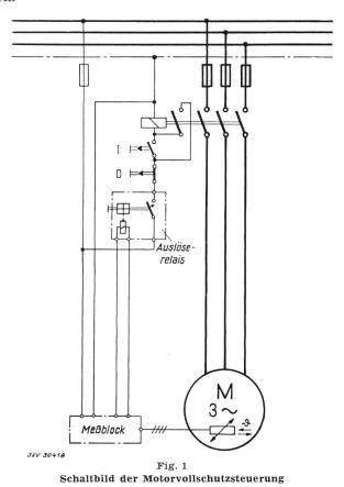
Üblicherweise wird in jede Phasenwicklung je einer der Temperaturfühler mit eingewickelt. Diese sind in einer Brückenschaltung mit dem in der Nähe des Motors angebrachten Messblock verbunden. Als einfaches und bequemes Mittel für die Verbindung zwischen den Anschlussenden der Fühler und den zum Messblock führenden Leitungen dient eine kleine Steckerkupplung, die im Motorklemmenkasten untergebracht wird. Der Messblock enthält, in Giessharz
