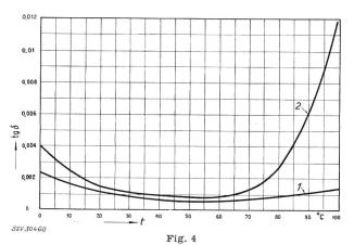
Facteur de pertes tg  $\delta$  de condensateurs à film polyester Comparaison de deux qualités de film polyester Fréquence 50 Hz, sollicitation 10 kV/mm t température
