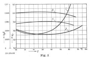
Constante diélectrique résultante  $\varepsilon_r$  et facteur de pertes tg  $\delta$  de condensateurs au papier imprégné en cires chlorées (Polychloronaphtalènes à bas point de fusion) stabilisées selon deux procédés différents
