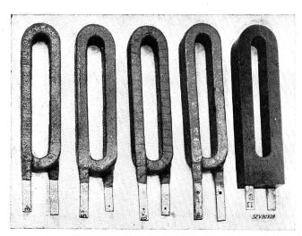
Fig. 1 Versuchsspulen für Erwärmungsversuche
