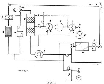
Vereinfachtes Schema der fahrbaren Ölaufbereitungsanlage
