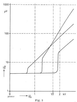
Radio-Störspannung  $U_s$  in  $\mu V$  als Vielfaches der Nennspannung  $U_n$  eines 72,5-kV-Giessharz-Spannungswandlers Dank der Vakuumanwendung übersteigt der Radiostörpegel den Umweltstörpegel erst bei höheren Spannungen
