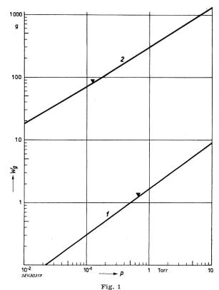
Wassergehalt  $W_g$  von Papier und Öl eines 300-kV-Stromwandlers in Funktion des Dampfdruckes p
