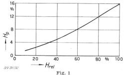
Valeur finale de la teneur en humidité du papier imprégné placé dans de l'air à 20 °C en fonction de l'humidité de l'air  $H_p$  Humidité dans le papier;  $H_{rel.}$  Humidité de l'air
