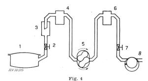
Schéma d'une installation d'imprégnation de câbles à masse 1 Cuve d'imprégnation; 2 Vanne; 3 Retenue de masse; 4 Conden-
