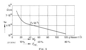
Abhängigkeit des spezifischen Widerstandes  $\varrho$  vom Wassergehalt  $W_g$  des Öles Die Kurve gilt für ein gebräuchliches Transformatorenöl
