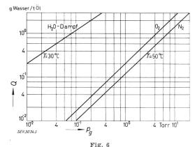
Absorptionsisothermen für Wasserdampf, Sauerstoff und Stickstoff Q absorbierte Gas- oder Dampfmenge;  $p_g$  Dampfdruck; T Temperatur
