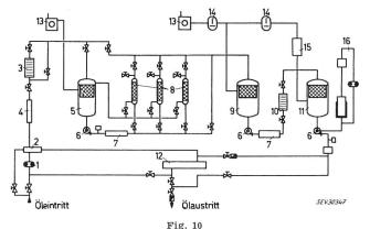
Kombinierte Aufbereitungs- und Regenerier-Anlage 1 Förderpumpe; 2 Mengenregler; 3 Filterpresse; 4 Kühler; 5 Entgasungskessel 1. Stufe; 6 Umwälzpumpen; 7 Ölwärmer 25 kW; 8 Fullerkessel; 9 Entgasungskessel 2. Stufe; 10 Filterpresse; 11 Entgasungskessel 3. Stufe; 12 Ölwärmer 120 kW; 13 Drehschieberpumpen  $S=100 \, \mathrm{m^3/h};$  14 Rootspumpen  $S=1600 \, \mathrm{m^3/h};$  15 Kondensator; 16 Inhibieranlage
