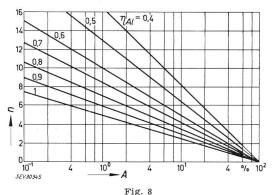
Graphische Darstellung des Gesamtwirkungsgrades  $\eta_{Al}$  einer Ölaufbereitungsanlage in Abhängigkeit von der Zahl der Umwälzungen n
