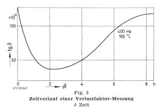
Dieser Effekt ist auch bei tieferen Temperaturen bei Messungen über längere Zeitabschnitte beobachtbar. Es ist daher nicht ratsam, die Zellentemperatur über den genormten Wert von 90 °C zu treiben.
