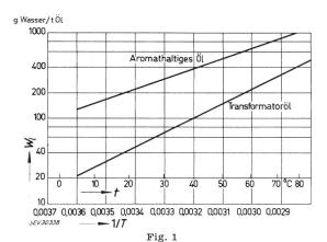
Maximale Wasserlöslichkeit  $W_1$  in Funktion der Öltemperatur t absolute Temperatur
