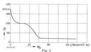
Zusammenhang zwischen Durchschlagfestigkeit  $U_d$  und Wassergehalt  $W_g$  von Neuölen nach [5]
