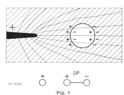
Schematische Darstellung der elektrischen Kräfte, die auf eine Gasblase im inhomogenen Feld wirken DP elektrischer Dipol mit Moment m=Ql
