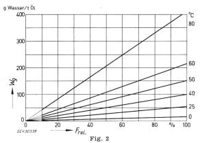
Wassergehalt  $W_g$  des Öles in Abhängigkeit von der relativen Feuchtigkeit  $F_{rel.}$
