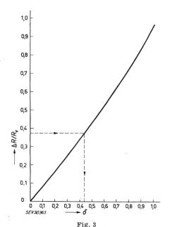
Indice de modulation  $\Delta R/R_v$  en fonction de la densité d'impression  $\delta$
