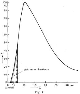
Répartition spectrale de l'émission d'une lampe à incandescence de 25 W (Température de la couleur: 2500 °K) E répartition de l'énergie de la lampe; λ longueur d'onde
