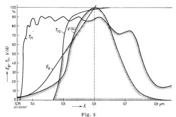
Emission relative de la lampe et transmission de filtre en comparaison de la courbe de sensibilité spectrale de la photorésistance  $\lambda$  longueur d'onde;  $T_{f1}$  transmission relative du filtre à interférences;  $T_{f2}$  transmission relative du filtre coloré;  $V(\lambda)$  sensibilité spectrale de la photorésistance;  $E_g$  émission spectrale de la lampe en rapport avec la valeur d'émission à 0,6  $\mu$ m
