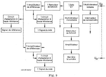
Schéma de principe de l'appareil de lecture  $U_{St}$  signal de commande
