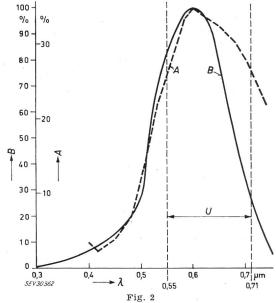
Adaptation optique entre la réémission spectrale des caractères de code et le spectre de sensibilité des photoéléments A différence de réémission entre jaune-violet; B courbe de sensibilité spectrale de photorésistance CdS; Région U: domaine de la différence de réémission maximale; \lambda longueur d'onde
