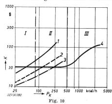
Die Herstellungskosten von Thermopaaren für thermoelektrische Kälteerzeugung im Vergleich zu den Kosten eines Kaltdampf-Kältekreislaufes
