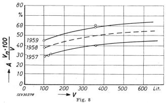
Zunahme der Raumausnützung bei Haushalt- und Gewerbekühlschränken durch bessere Konstruktionen und verbesserte Kälteschutzstoffe
