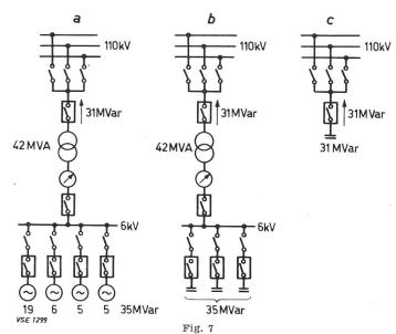
Frais annuels d'une installation de compensation d'énergie réactive a schéma d'une installation de compensation de phase utilisant des machines tournantes
