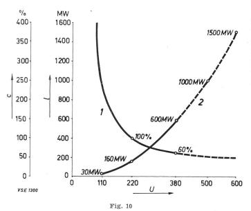
Puissance naturelle et coût d'établissement spécifique d'une ligne de 350 km en fonction de la tension de transport
