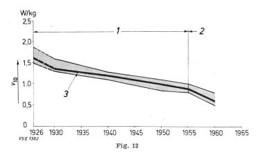
Pertes dans le fer des tôles de transformateur
