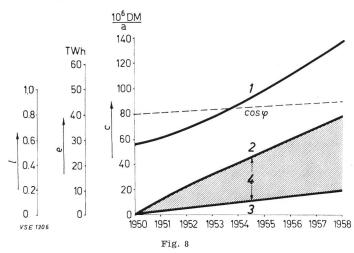
Estimation de l'économie réalisée par réduction des pertes dans le réseau public de distribution d'Allemagne occidentale, de 1950 à 1958, grâce à la compensation de l'énergie réactive
