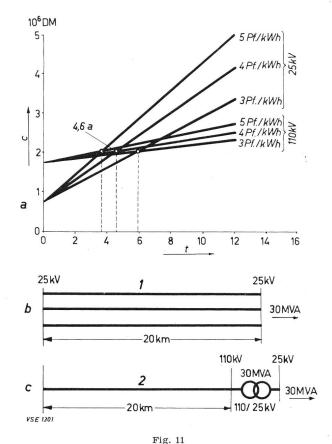
Rentabilité d'un transport à 110 kV en comparaison d'un transport à 25 kV
