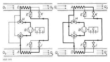
Fig. 2 Schéma d'une pompe de chaleur air-air réversible
