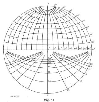
Azimutale Darstellung einer halben Kugeloberfläche Auf der oberen Hälfte mit dem normalen Koordinatennetz von Meridianen und Breitenkreisen, auf der untern Hälfte mit dem (x-y)-Netz überzogen
