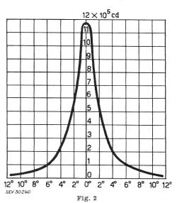
Lichtverteilung einer Leuchte mit sehr engem, rotationssymmetrischem Lichtbündel (Scheinwerfer)
