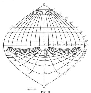
Sinusoidale Darstellung einer halben Kugeloberfläche Auf der obern Hälfte mit dem normalen Koordinatennetz von Meridianen und Breitenkreisen, auf der untern Hälfte mit dem (x-y)-Netz überzogen
