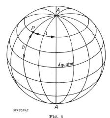
Bestimmung der Lage eines Punktes P auf der Kugeloberfläche mittels der Länge l und der Breite b
