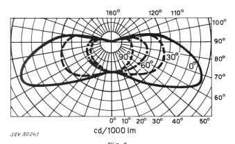
Fig. 3 Lichtverteilung einer Leuchte mit nichtrotationssymmetrischem Lichtbündel
