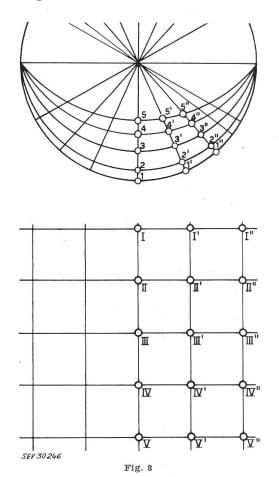
Kugeloberfläche mit dem rückprojizierten Rechenpunktenetz  $[(y-x) \ {f Netz}]$
