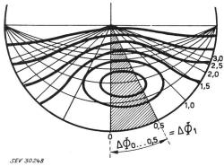
Fig. 10 Berechnung der Teillichtströme  $\Delta \varPhi_1, \ \Delta \varPhi_2 \dots$  zwischen den y-Meridianen
