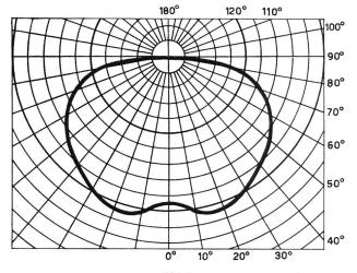
Fig. 1 Lichtverteilung einer Leuchte mit rotationssymmetrischem Lichtbündel
